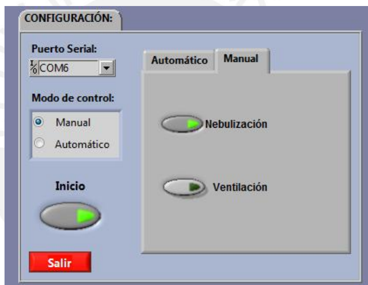
Figura 4.9 Panel de modo manual, en el cual se muestra los botones para el encendido de la etapa de nebulización y ventilación.
