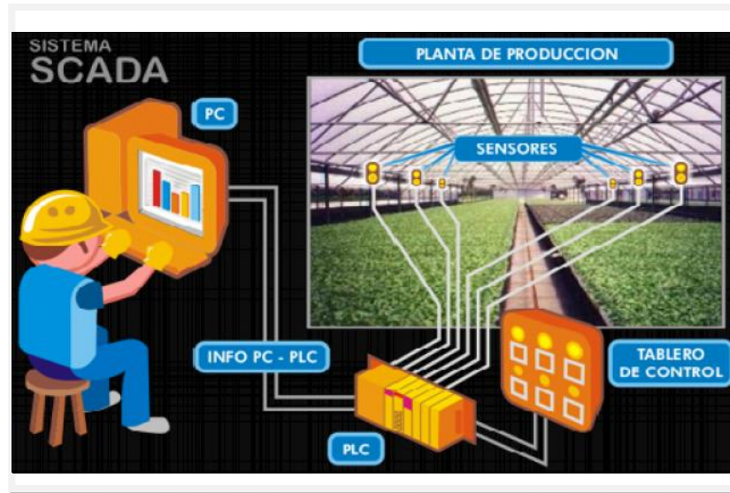
Figura 2.4 Sistema SCADA en un invernadero
