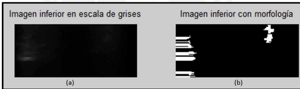
Figura 4.8. Comparación de la ecografía con la imagen procesada morfológicamente de un paciente sano. En (a) mitad inferior de la ecografía. En (b) mitad inferior del resultado del proceso morfológico.
