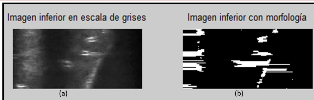
Figura 4.10. Comparación de la ecografía con la imagen procesada morfológicamente de un paciente enfermo. En (a) mitad inferior de la ecografía. En (b) mitad inferior del resultado del proceso morfológico.
