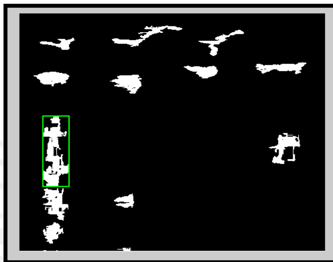
Figura 3.11. Proceso de detección visual por el algoritmo de umbralización
