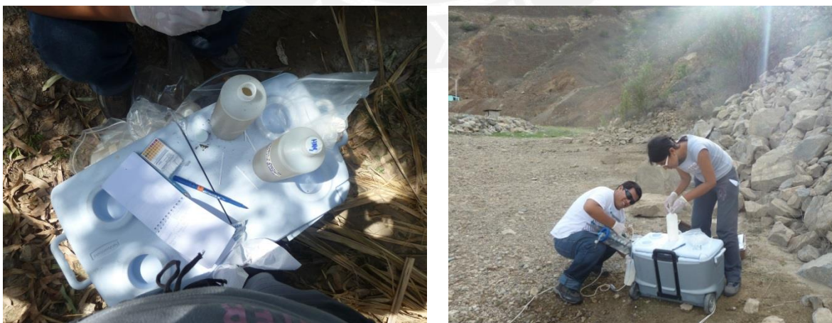
Figura 18. Preservación y almacenamiento de muestras. Materiales utilizados para la preservación de muestras (izquierda). Disposición y preservación de las muestras mediante la metodología correspondiente (derecha). Fotografías del Proyecto DGI 2010.0110
