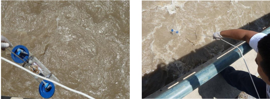
Figura 17. Muestreo de agua con botella Van Dorn. Disposición de la botella de Van Dorn para los muestreos (izquierda). Muestreo de agua en la estación E1 desde la zona intermedia del puente (derecha). Fotografías del Proyecto DGI 2010.0110
