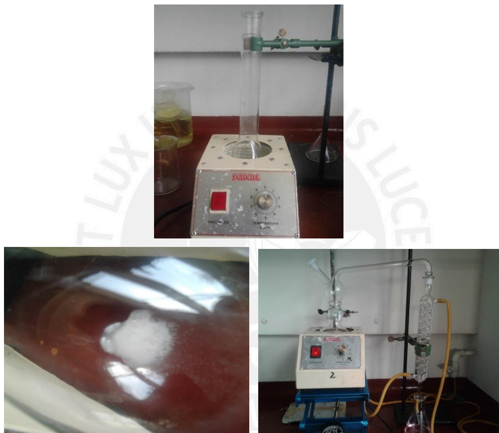
Figura 22. Digestión para el análisis de Kjeldahl. Sistema de digestión (superior). Sulfato de amonio resultante del proceso de digestión (izquierda). Sistema de destilación (derecha). Fotografías del autor
