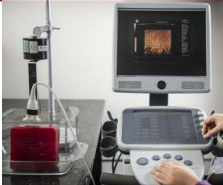
Figura 13 Fotografía de un ensayo experimental, en donde se observa al transductor conectado al vibrador y registrando las señales de radiofrecuencia estando conectado al sistema ultrasónico
