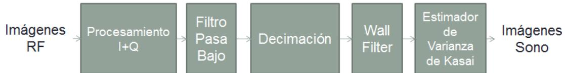
Figura 3 Esquema del Algoritmo para la generación de sonoelastografía cualitativa
