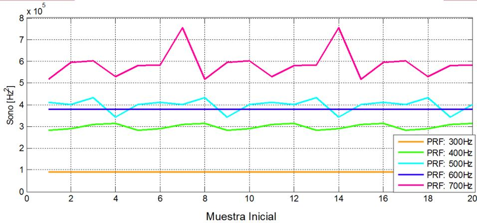
Figura 22 Simulación de la varianza sonoelastográfica ante variaciones de la fase inicial, en el punto [45 25] para valores de *PRF*: 300, 400, 500, 600, 700 Hz, con variación a amplitud de vibración 30  $\mu\text{m}$ .
