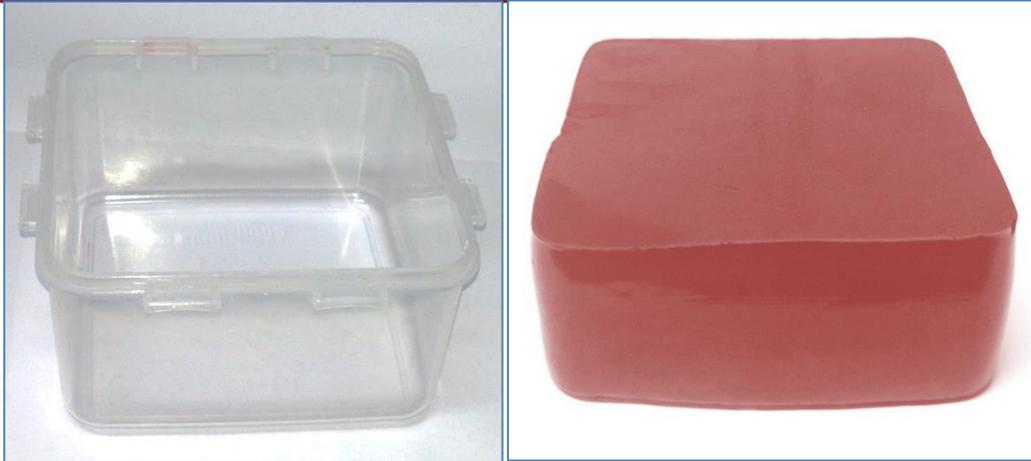
Figura 9 De izquierda a derecha, (a) Molde empleado para la elaboración del maniquí. (b) Maniquí homogéneo de experimentación.
