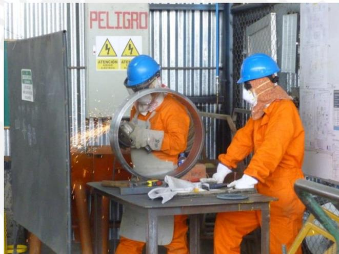
Fig. 2.7 Limpieza y preparación de bordes del anillo ASTM A707 L5 F65
