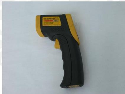
Fig. 2.9 Medidor infrarrojo de temperatura
