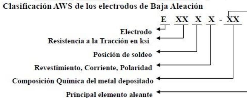
**Fig. 2.4** Designación de electrodos según AWS A5.5 (AWS 1996:31)
