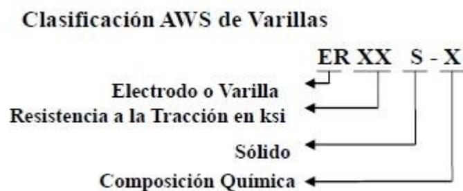
**Fig. 2.3** Designación de varillas según AWS A5.18 (AWS 2001:20)
