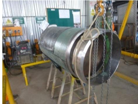
Fig. 2.8 Posicionamiento de las piezas a soldar con ayuda de un tecele
