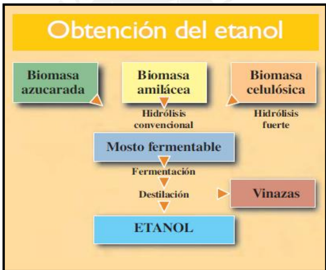
Figura 1.2 - Proceso de obtención de etanol [22].
