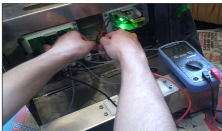
Figura 3.1: Ensayo de la Fuente de Alimentación
