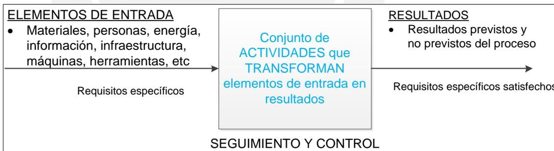
Figura 10: Esquema básico de un proceso general
