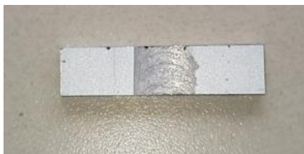
Figura 2. 10 Probeta para inmersión de todas las regiones
