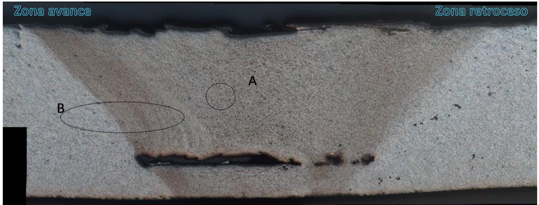
Figura 3. 3 Macrografía de la zona procesada probeta 1 (600RPM, 60mm/min)
