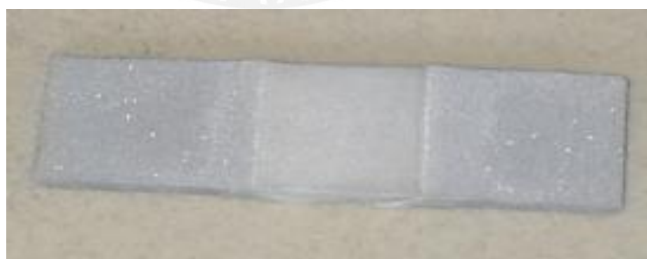
Figura 3. 40 PROBETA 3 (600 RPM, 120 mm/min) después de 144 horas sumergidas en HCl
