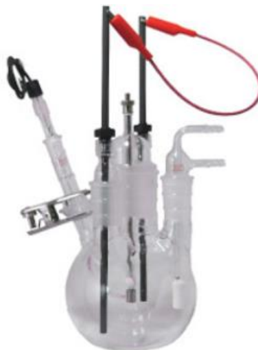
Figura 2. 15 Celda de corrosión modelo K47
