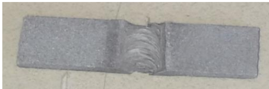
Figura 3. 41 PROBETA 2 (600 RPM, 100 mm/min) después de 144 horas sumergidas en HCl
