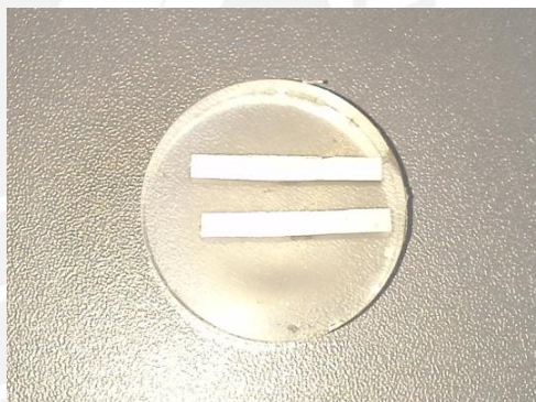
Figura 2. 20 Probetas embriquetadas para ensayos metalográficos y macrográficos
