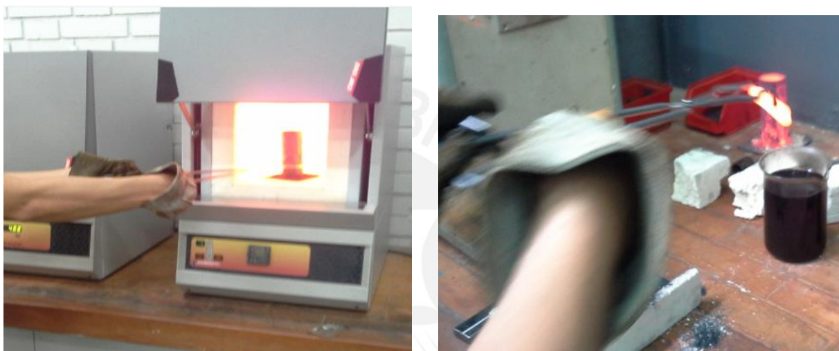
Figura 2. 3 Tratamiento térmico a la herramienta del proceso de fricción batido
