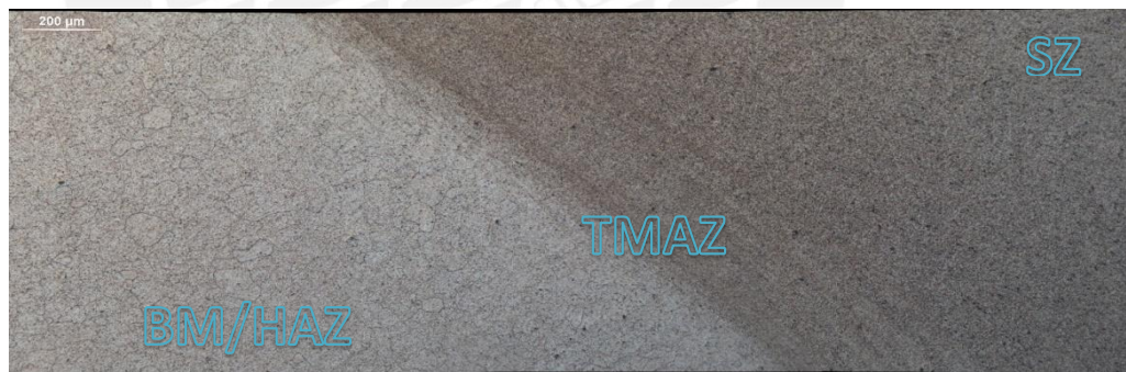
Figura 3. 15 Partes de la zona procesada probeta 4 (600 RPM y 160 mm/min)
