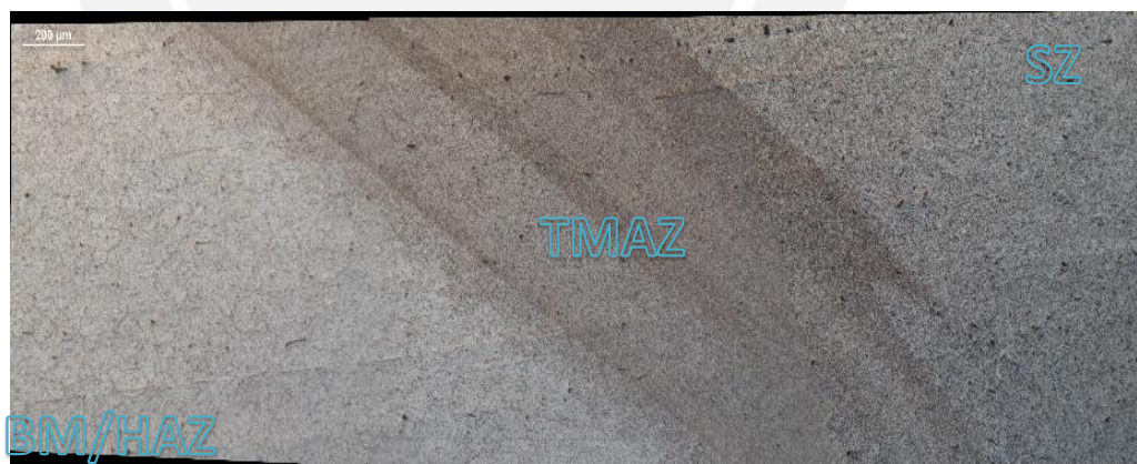
Figura 3. 9 Partes de zona procesada probeta 2 (600 RPM y 100 mm/min)
