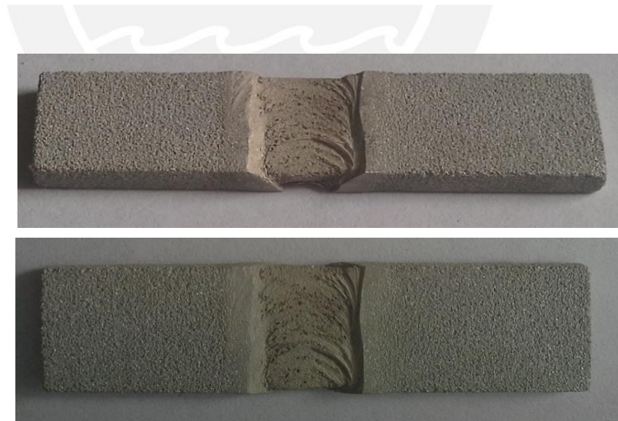
Figura 3. 43 PROBETA 4 (600 RPM, 160 mm/min) después de 144 horas sumergidas en HCl
