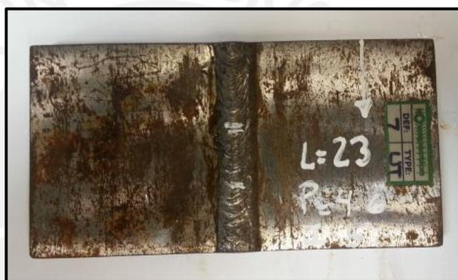
Figura 3.10 - Marcado de Indicación en la probeta N°7
