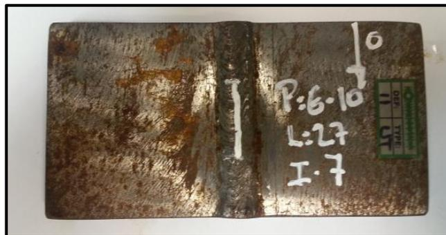
Figura 3.8- Marcado de Indicación en la probeta N°11
