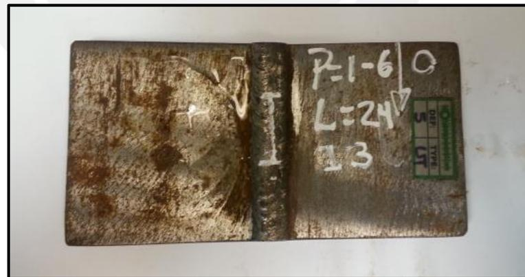
Figura 3.6 – Marcado de Indicación en la probeta N°5.
