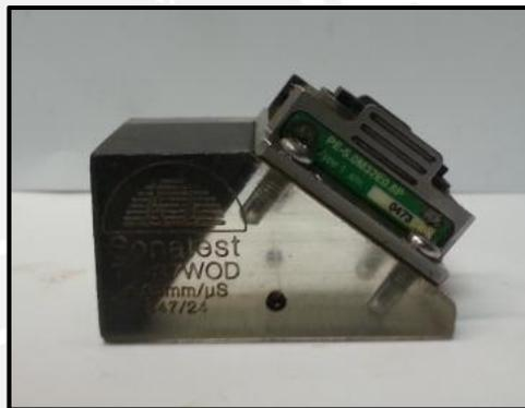
Figura 2.3 – Zapata a utilizar en el ensayo de UTPA
