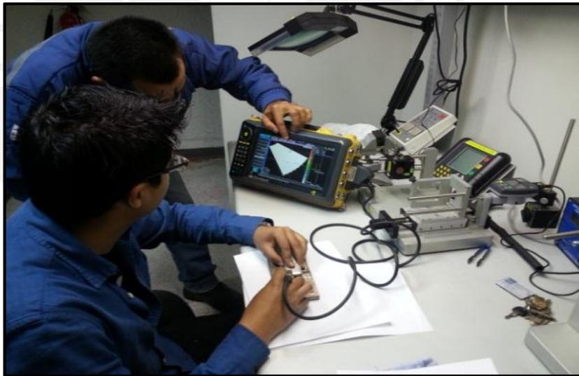
Figura 2.17 – Ensayo de probeta Mediante UTPA
