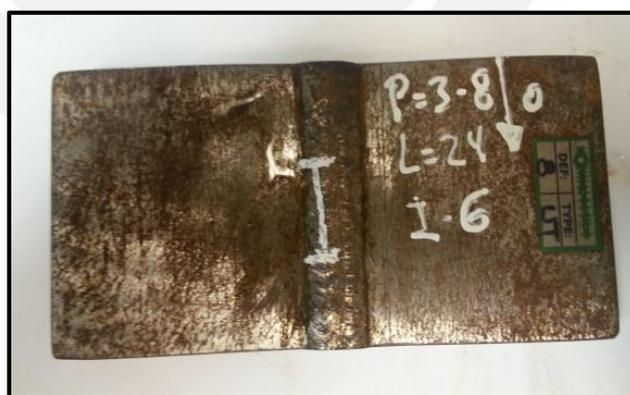
Figura 3.12 - Marcado de Indicación en la probeta N°8
