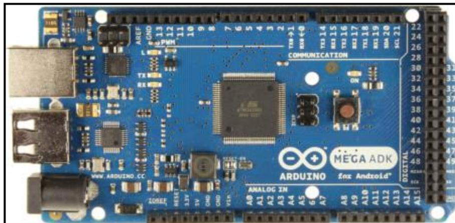
Fig. 3-17: Arduino MEGA ADK (Fuente:www.arduino.cc)
