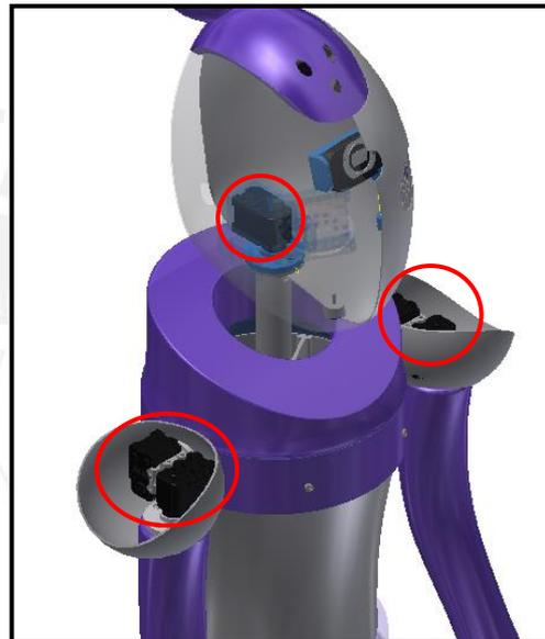
Fig. 3-9: Ubicación de servomotores (Fuente: Propia)
