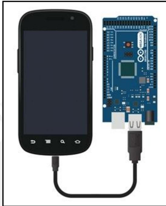
Fig. 3-31: Tablet+ArduinoMEGA ADK (Fuente: [www.adafruit.com](http://www.adafruit.com))
