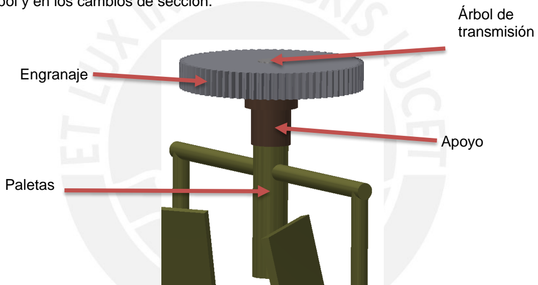
Figura 2.31: Elementos de árbol [Elaboración propia]
