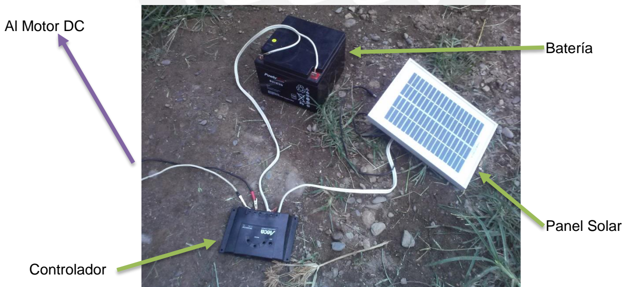
Figura 2.30: Sistema de alimentación a usar [Elaboración propia]
