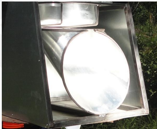
Figura 3.5: Foco del Scheffler en el tostador [Elaboración propia]
