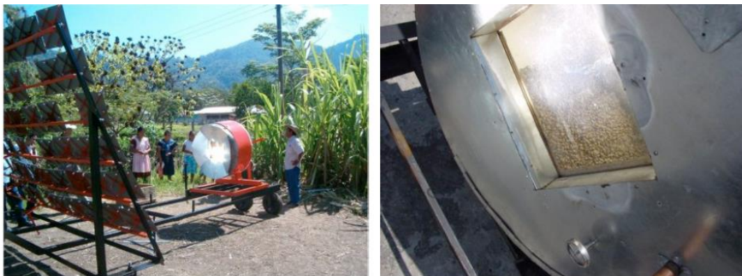
Figura 1.7: Concentrador “Fuego Solar” en funcionamiento [Francois Veynandt, 2012]
