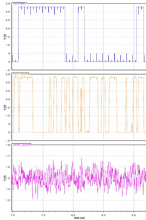
Figura 4.5: Formas de onda de salida con ruido.
