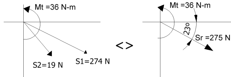
Figura 3. 2 Trasmisión de fuerzas y momentos debido a la faja
