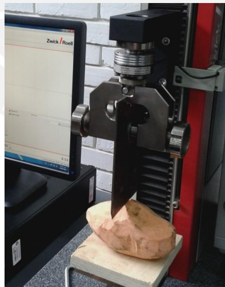
Figura 1. 7. Fotografía de ensayo de corte en máquina Zwick
