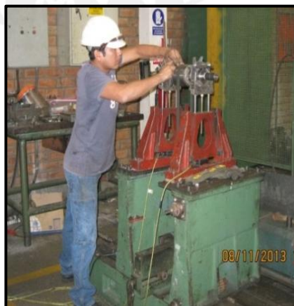
Figura 4.10 Puesto N°10- Balanceador Elaboración Propia
