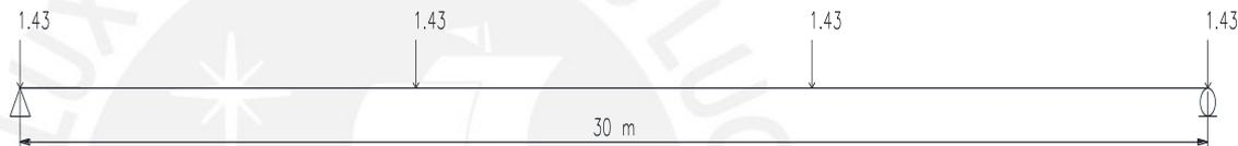
Figura 26. Cargas de diafragmas en viga prefabricada.
