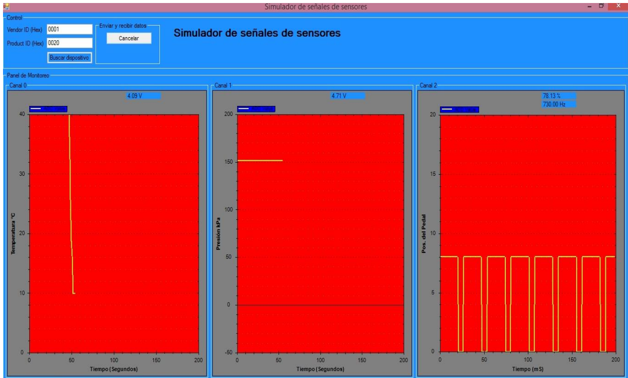
Fig 6: Pantalla de monitoreo de las señales simuladas por la tarjeta electrónica
