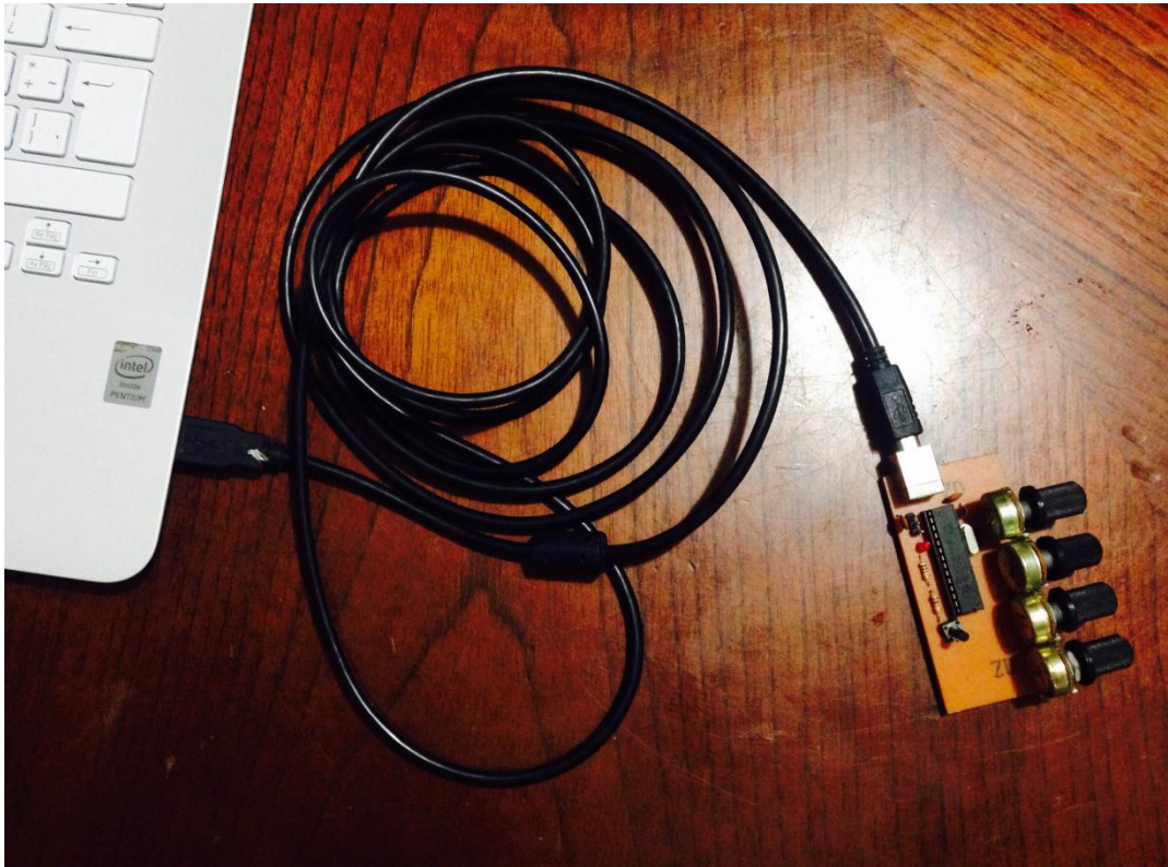
Fig 3: Conexión entre la tarjeta Simuladora de Señales y computadora mediante el uso de un cable USB de impresora
