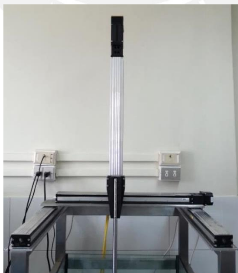
Figura 10 Sistema posicionador de 3 ejes con rieles 403T06XES – Parker [19]
