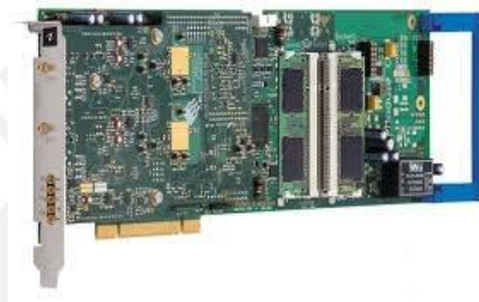
Figura 9 Tarjeta de adquisición UF3-4142 – Strategic-Test, tomado de [15].
