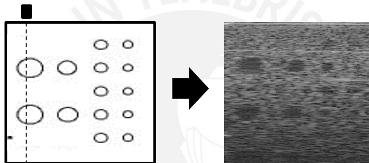
Figura 44 Formación de imagen ultrasónica en modo-B
