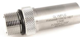
Figura 8 Transductor de inmersión fabricado por Olympus, tomado de [14].
