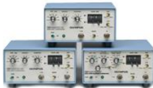
Figura 5 Equipos excitadores de ultrasonidos Panametrics-NDT modelos 5072PR, 5073PR, 5077PR fabricado por Olympus, tomado de [13].
