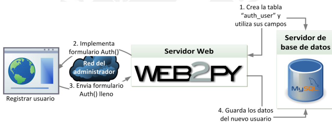
Figura 3.25. Diagrama de funcionamiento de la funcionalidad "Registrar usuario" [Elaboración propia]
