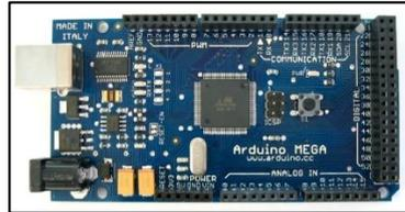
Fig. 3.2 – 13: Arduino Mega 2560
