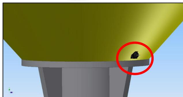
Fig. 3.2 – 4: Ubicación del sensor de presencia de líquido
