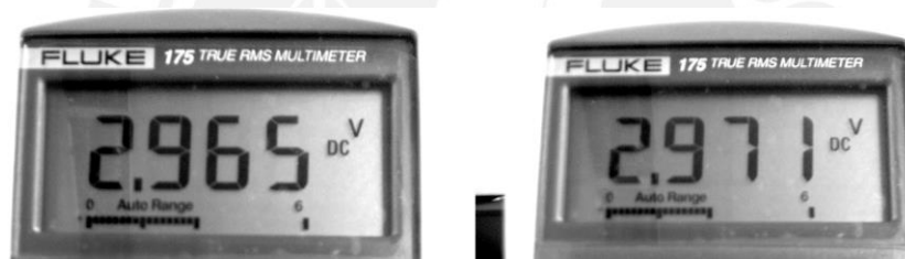
3- Figura 4.7 Recarga medida en una batería
