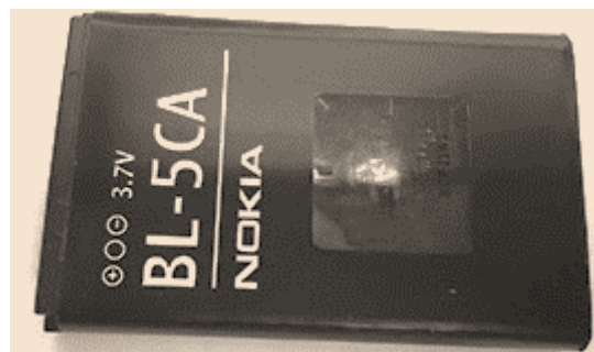
Figura 3.5 Batería litio – ion
