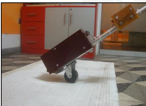
Gráfico 10. Los sensores no envían la señal alerta al superar el desnivel y no detectar un obstáculo próximo.
