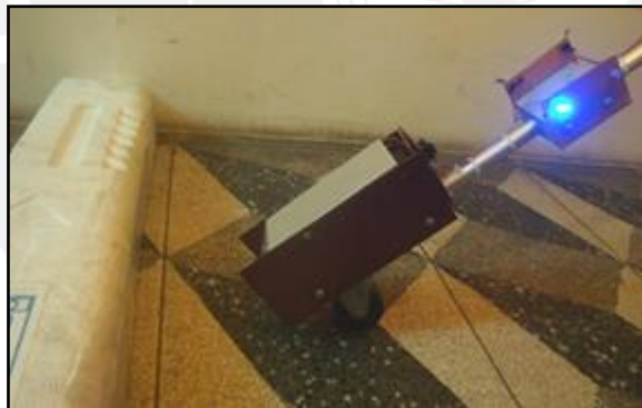
Gráfico 6. Detección de una grada a una distancia de 10 centímetros
