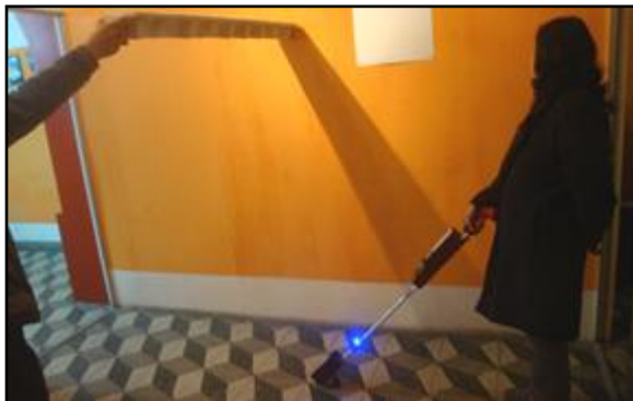
Gráfico 3. Detección de objeto a una altura de 155 centímetros
