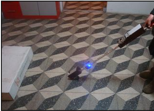
Gráfico 8. Detección de un desnivel, alerta enviada por la sección detección de objetos.
