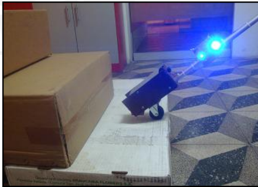
Gráfico 11. Detección de gradas, alertas enviadas por ambas secciones de detección.
