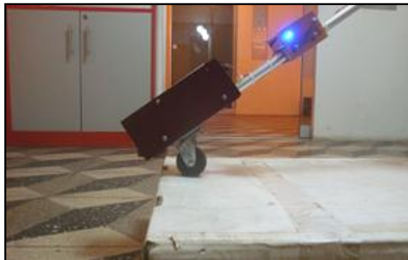
Gráfico 7. Detección de un desnivel de 10 centímetros de alto
