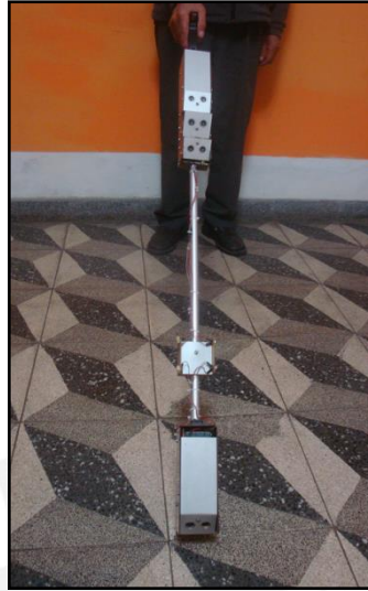
Gráfico 42. Prototipo del dispositivo electrónico para personas ciegas implementado.
