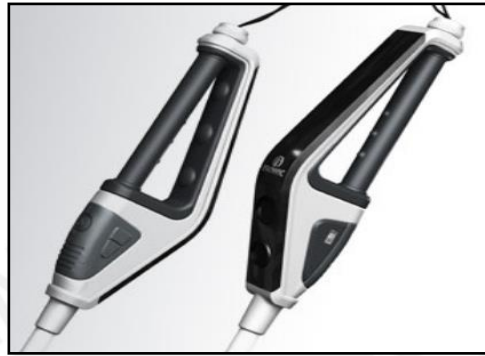
Gráfico 17. iSONIC. Detecta obstáculos a través de ultrasonido. [40]
