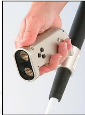
Gráfico 15. K-Sonar. Utiliza el ultrasonido para la detección. [38]
