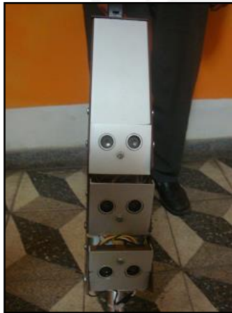
Gráfico 43. Vista frontal de la parte encargada de la detección de objetos.
