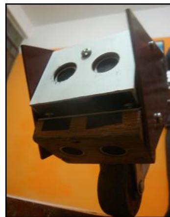
Gráfico 46. Parte encargada de la detección de desniveles vista desde abajo.
