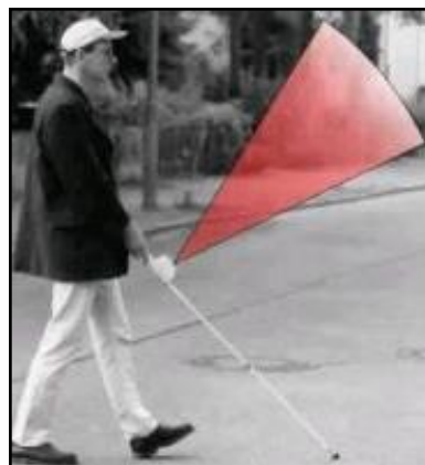
Gráfico 18. Long Laser Cane. Detecta los obstáculos a través de láser. [41]
