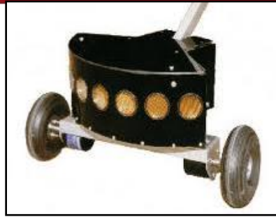
Gráfico 13. GuineCane. Compuesto por diez sensores ultrasónicos. [36]
