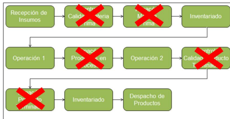
Figura 1.8 Proceso productivo con Kanban Fuente: Ballou (2004) Elaboración propia
