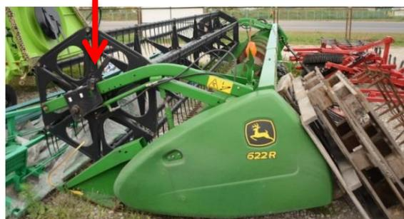
Figura 2.11: Mecanismo tipo tambor para sujeción
