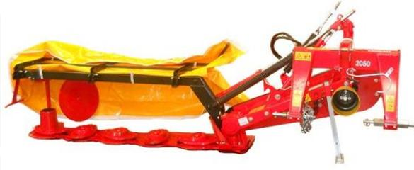
Figura 2.5: Máquina segadora de discos (mecanismo sin contracuchilla)
