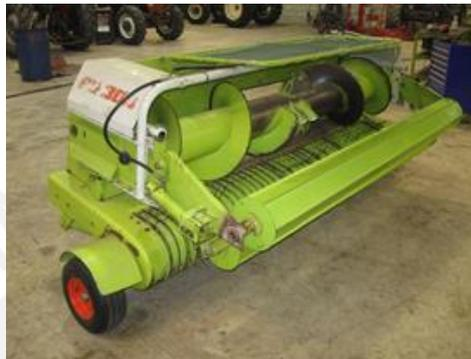
Figura 2.12: Mecanismo con hélice para el retiro de plantas segadas
