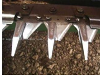
Figura 2.4: Cuchilla y contracuchilla de la máquina segadora
