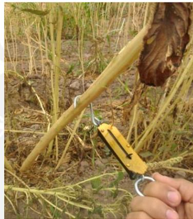
Figura 3.47: Ensayo para la obtención de la fuerza de alimentación
