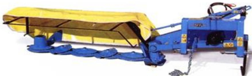
Figura 2.9: Máquina segadora rotativa de discos
