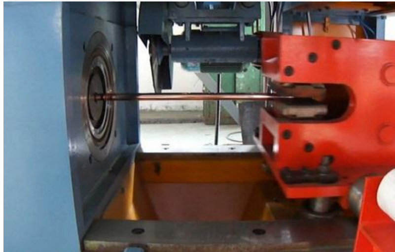
Figura 1.11. Tubo de cobre siendo estirado. Vista del banco de trefilado. http://www.alibaba.com/product-gs/721512207/TUBE_DRAW_MACHINE.html
