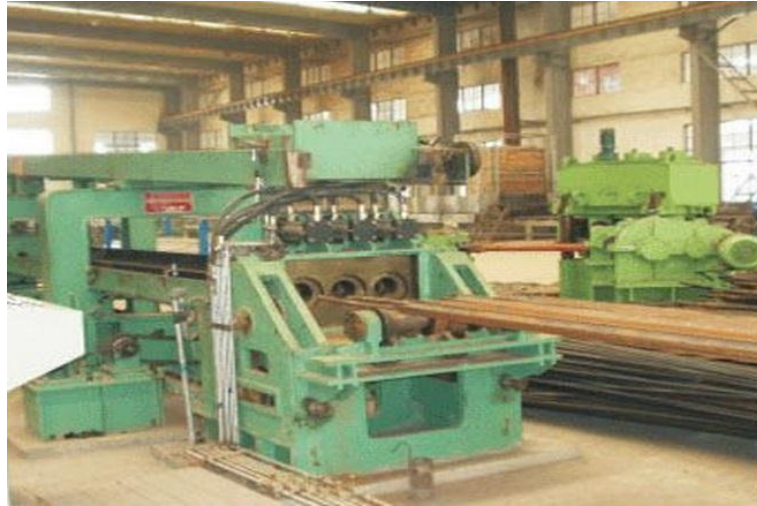
Figura 1.12. Máquina trefiladora de tubos movida por fuerza hidráulica.
