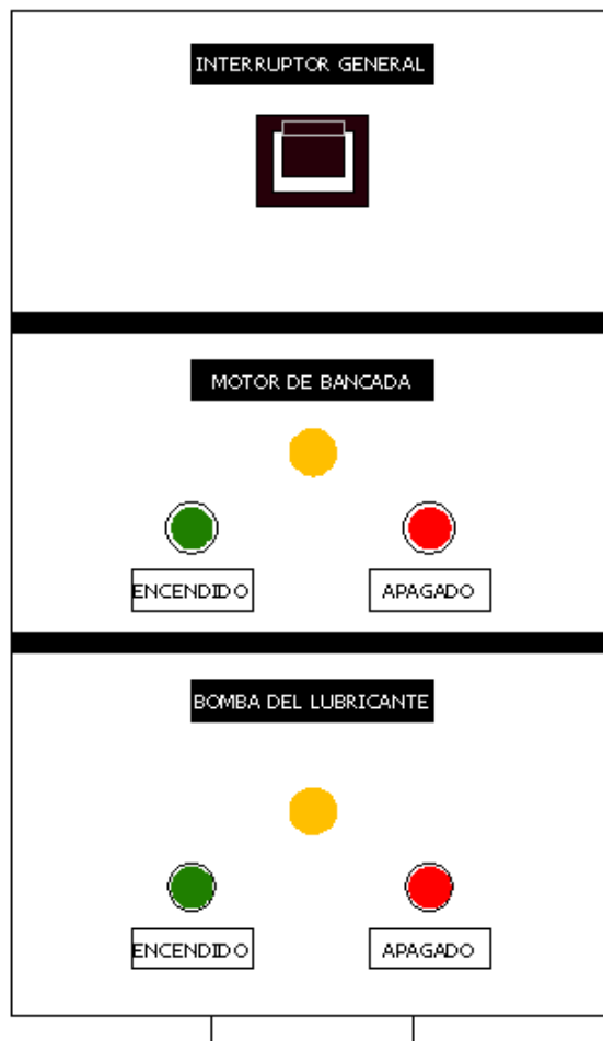
Figura 3.38. Esquema con los pulsadores y salidas del tablero de control de la máquina.
