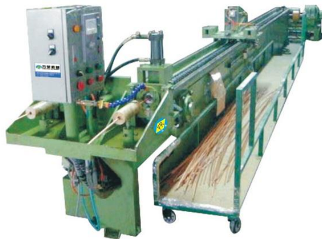
Figura 1.08. Banco de trefilado de precisión para tubos de cobre.
