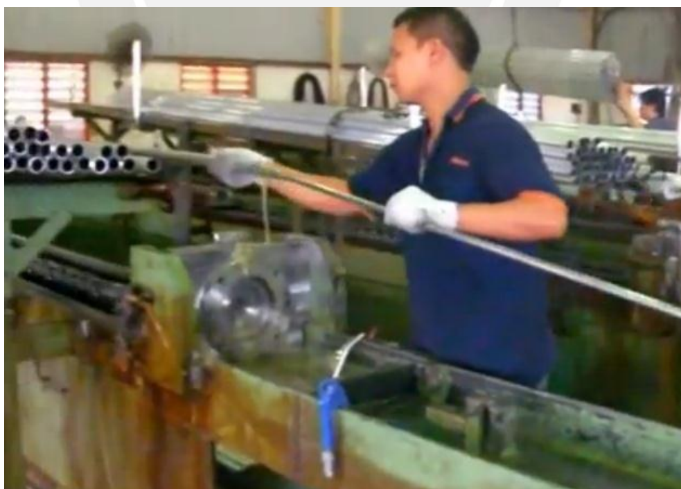
Figura 3.23. Operario preparando un tubo para ser estirado.
