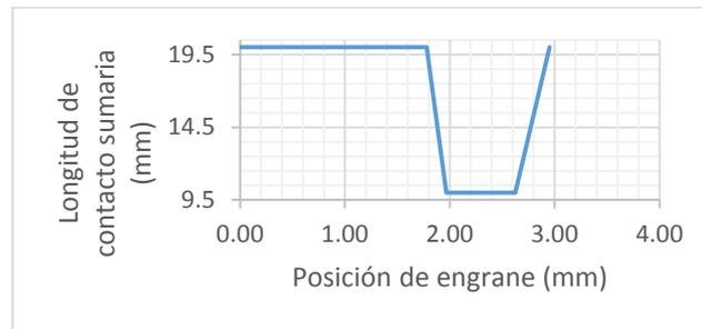
b. ( $m=1\text{mm}$ ,  $b=10\text{mm}$ ,  $z_1=29$ ,  $z_2=91$ ,  $x_1=0.5$ ,  $x_2=-0.1$ ,  $\beta=0^\circ$ )
