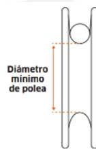
Figura 3.18. Relación entre diámetro mínimo del tambor y el diámetro del cable.
