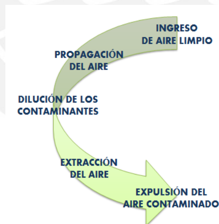
Figura 2.2 Principio de ventilación general
