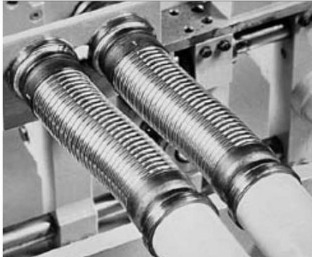
Ilustración 3.3. Junta de expansión de tejido metálico.
