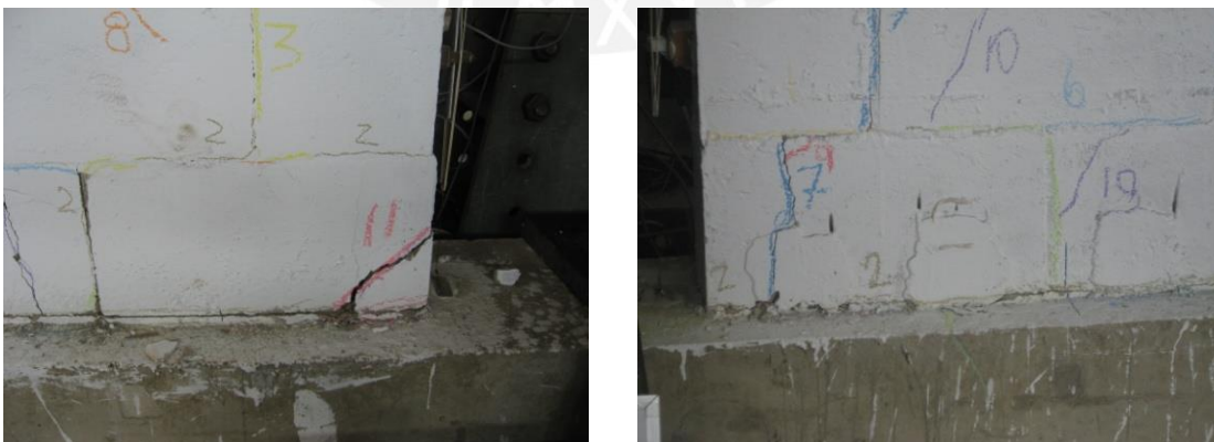
Fig.6.25. Fisuras en la fase 11, M1 (izquierda) y M2 (derecha)
