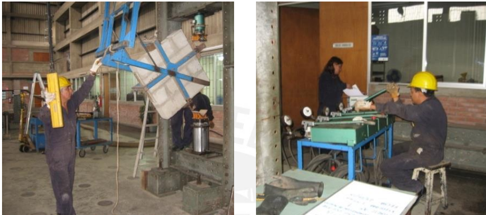
Fig.4.7. Montaje de muretes de albañilería (izquierda) y aplicación de carga (derecha)
