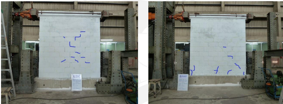
Fig.6.17. Fisuras en la fase 7, M1 (izquierda) y M2 (derecha).
