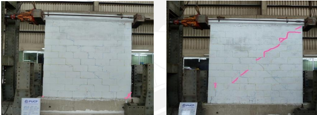
Fig.6.25. Fisuras en la fase 11, M1 (izquierda) y M2 (derecha)
