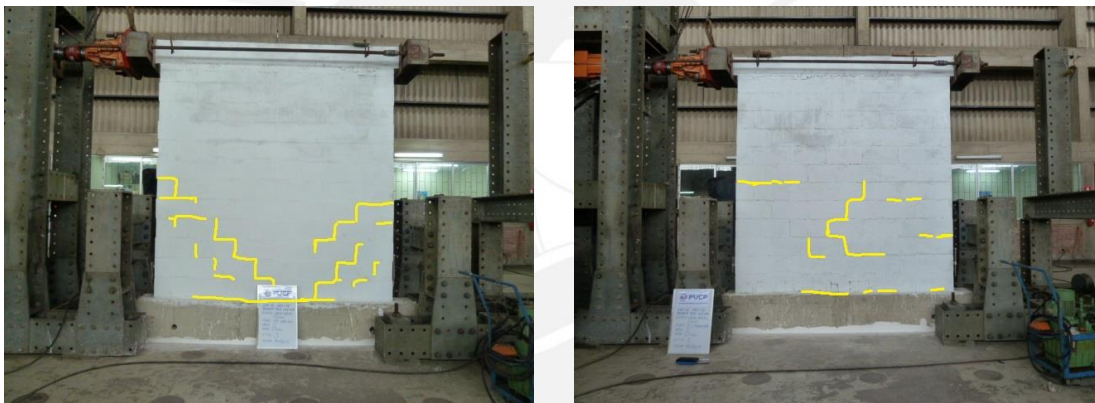
Fig.6.9. Fisuras en la fase 3, M1 (izquierda) y M2 (derecha)
