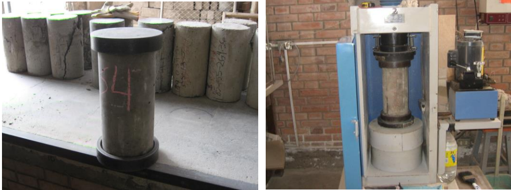
Fig.3.2. Probeta de concreto y dispositivo de ensayo.
