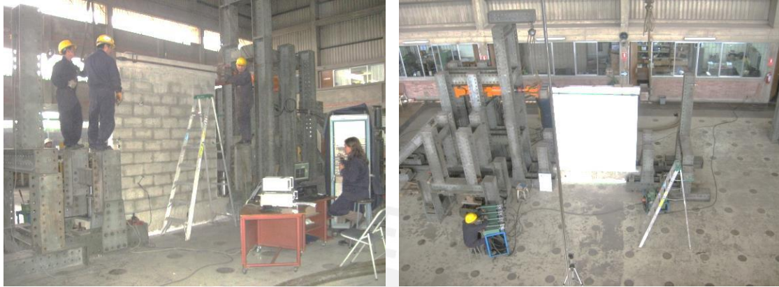
Fig.6.4. Precarga en muros (izquierda) e inicio de ensayo (derecha).
