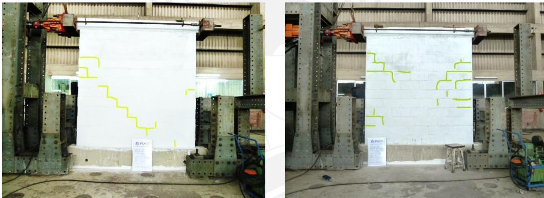
Fig.6.11. Fisuras en la fase 4, M1 (izquierda) y M2 (derecha)
