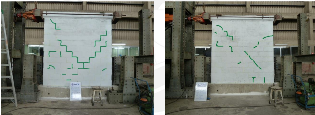
Fig.6.13. Fisuras en la fase 5, M1 (izquierda) y M2 (derecha).
