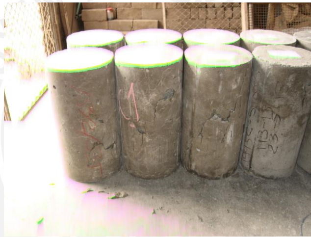
Fig.3.3. Probetas de concreto luego de la rotura.
