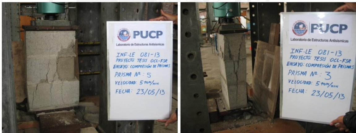
Fig.4.5. Falla de pilas de albañilería tradicional (izquierda) y junta seca (derecha).
