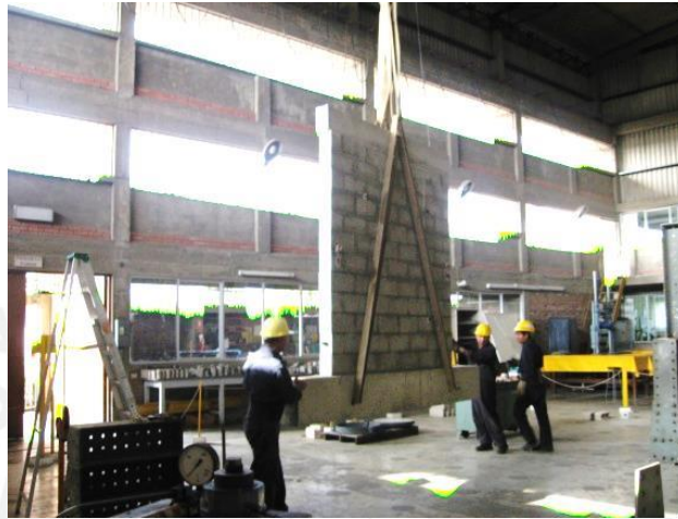
Fig.6.1. Transporte de los muros de albañilería armada a ensayar
