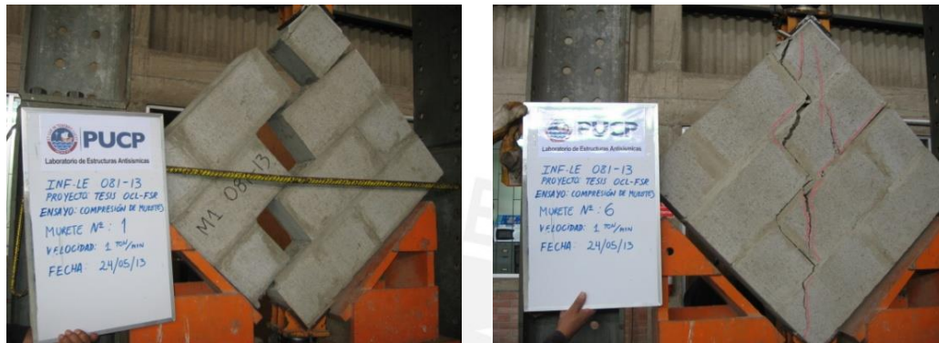
Fig.4.8. Falla de muretes de albañilería de junta seca (izquierda) y con mortero (derecha).
