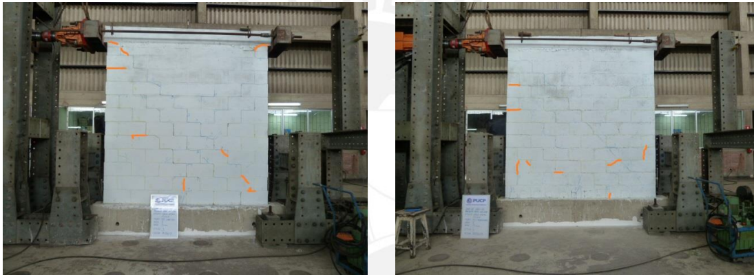
Fig.6.19. Fisuras en la fase 8, M1 (izquierda) y M2 (derecha)
