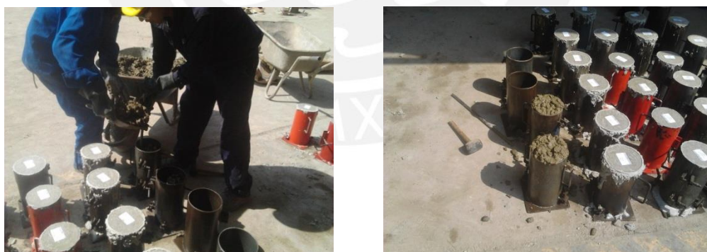
Fig. 3.1. Fabricación de las probetas de concreto.
