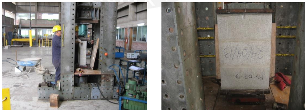
Fig.4.4. Montaje de las pilas de albañilería en la máquina de ensayos
