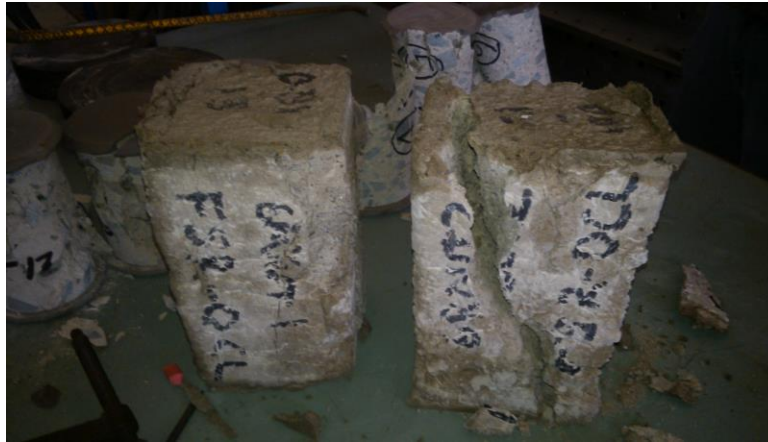
Fig.3.6. Falla por corte en probetas de grout.
