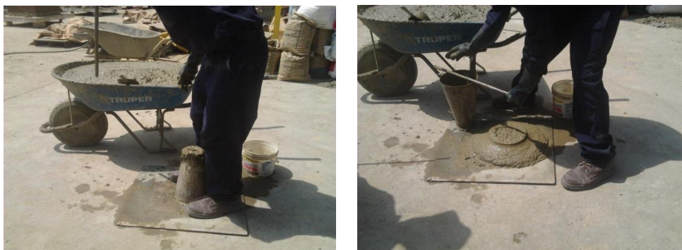
Fig.3.7. Llenado del molde y desmolde de una muestra de grout.
