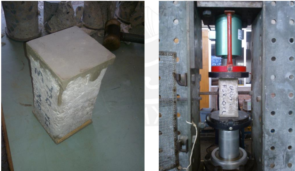
Fig.3.5. Probeta de Grout con capping y dispositivo de ensayo.
