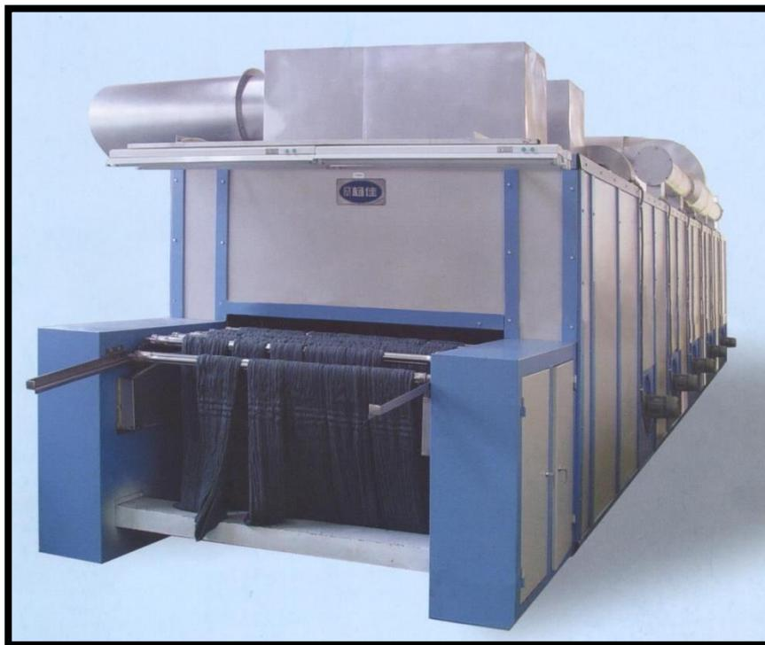
Figura 1.4. Horno de secado para madejas textiles. Fuente: [www.qrbiz.com](http://www.qrbiz.com)
