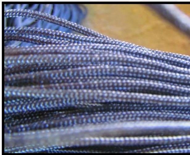
Figura 1.2. Cuerda trenzada a partir de fibras de poliéster. Fuente: Elaboración Propia.
