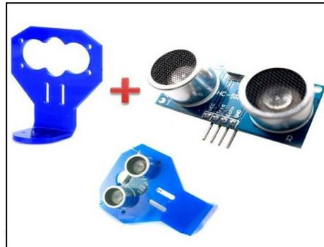
Fig. 3.2-5: Sensor de ultrasonido HC.sr04<sup>3</sup>
