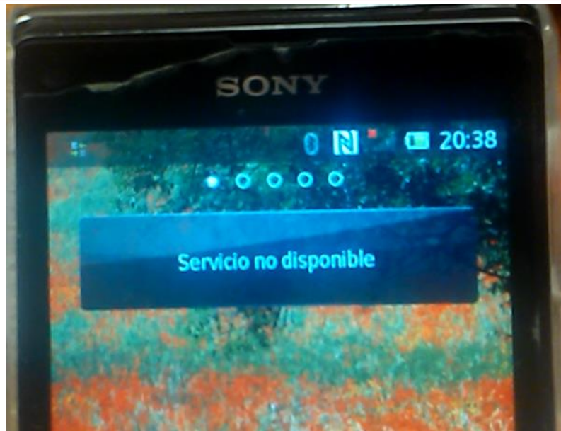
Figura 4. 6 Funcionamiento de los celulares con el Jammer encendido [Fuente: Elaboración propia]
