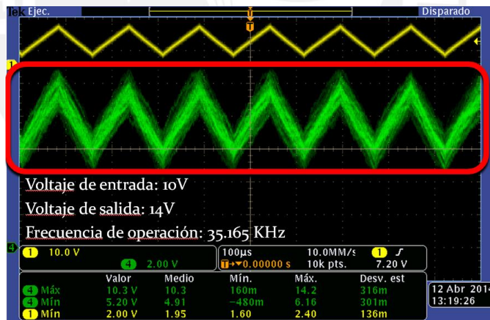
Figura 3. 10 Onda triangular con ruido [Fuente: Elaboración propia]
