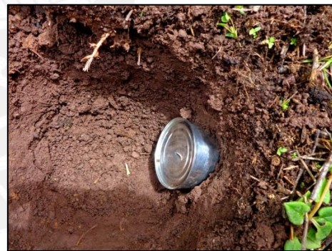
Figura 12: Inserción del cilindro de latón en la pared de la perforación para la el cálculo de la D.A.
