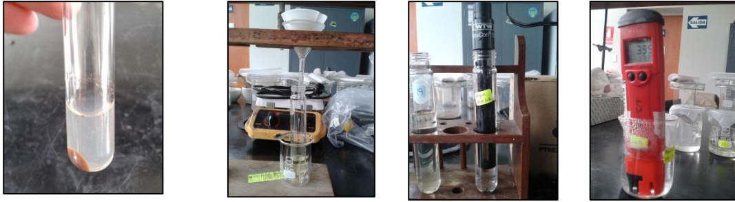
Sólidos luego de centrifugar a 3000 rpm. Filtrado de la solución Lectura de C.E. con el conductímetro Lectura de pH con el pH-metro
