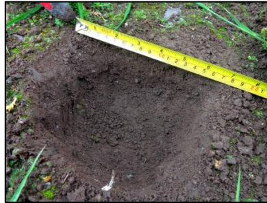
Medición del largo y ancho de la perforación
