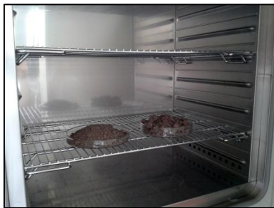
Muestras de suelo en placas petri dentro de la estufa a 105 °C
