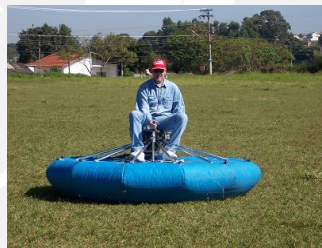
Figura 2.5 Hovery Hovercraft Modelo Hovery Standar – Forma circular
