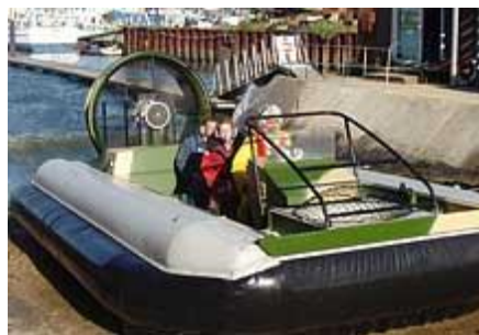
Figura 2.6 Griffon Hovercraft Modelo 380TD - Forma rectangular
