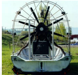
Figura 1.10 Hélice de 8 palas parte de un sistema de propulsión de un aerodeslizador
