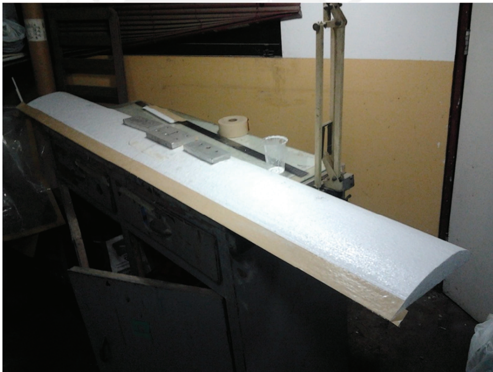
Figura 3. 5 Resultado del corte del ala con la máquina CNC y refuerzo del borde de salida con papel engomado. [Autoría propia, 2012].
