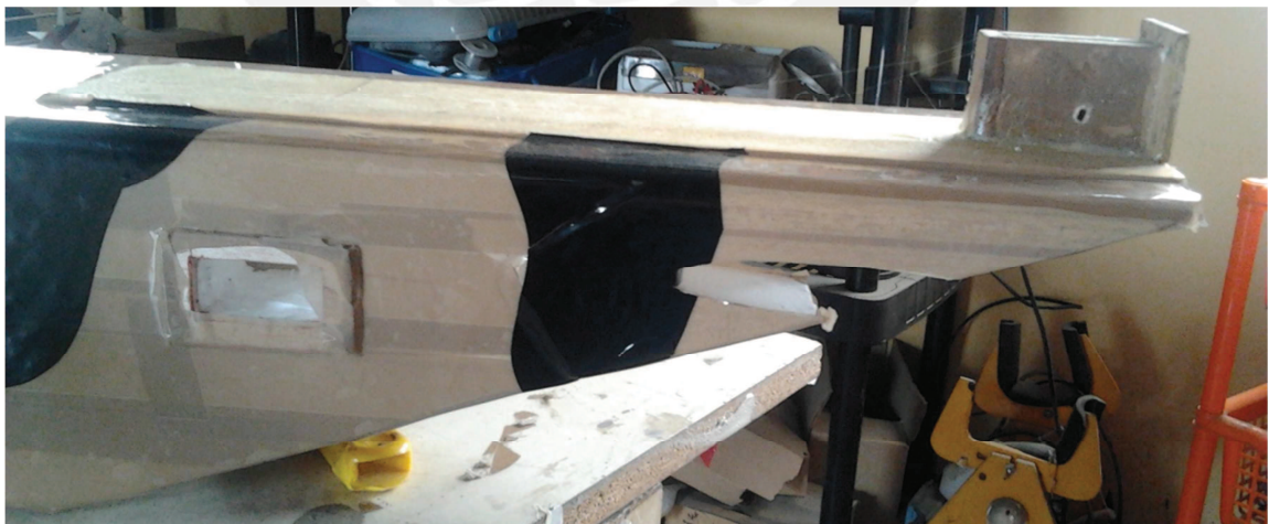
Figura 3. 17 Detalle de la cavidad para la instalación del servo del elevador. [Autoría propia, 2012].
