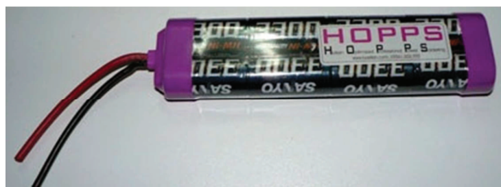
Figura 1. 22 Batería de Níquel-Hidruro Metálico. [Carlos Martín, 2005].
