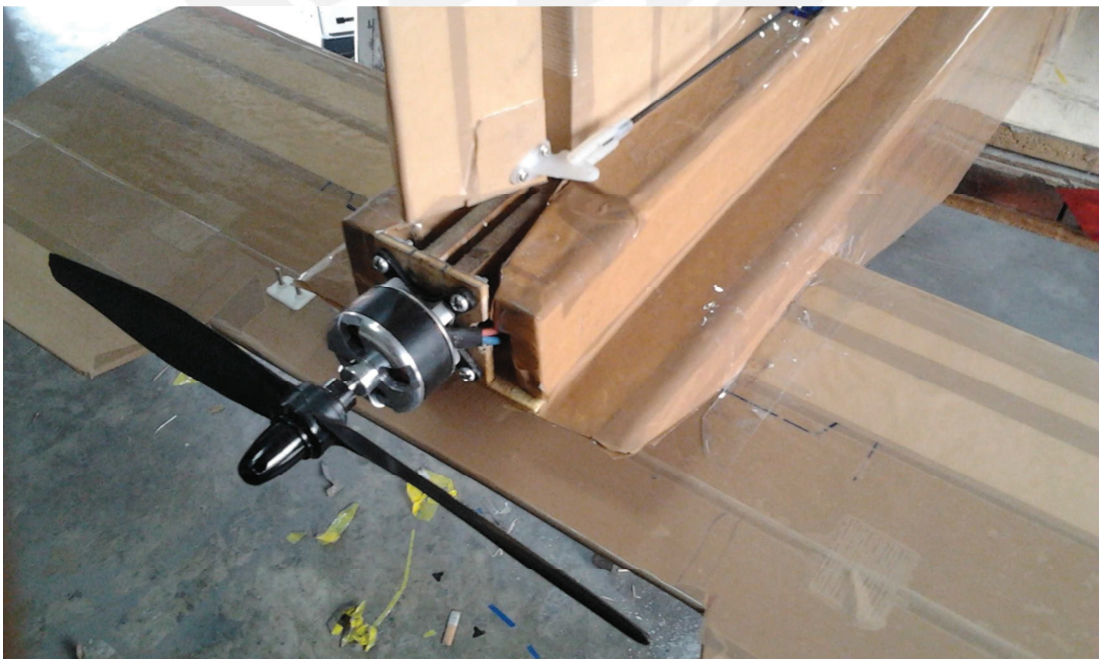
Figura 3. 21 Detalle de instalación del motor sobre el banco preparado especialmente para este fin. [Autoría propia, 2012].
