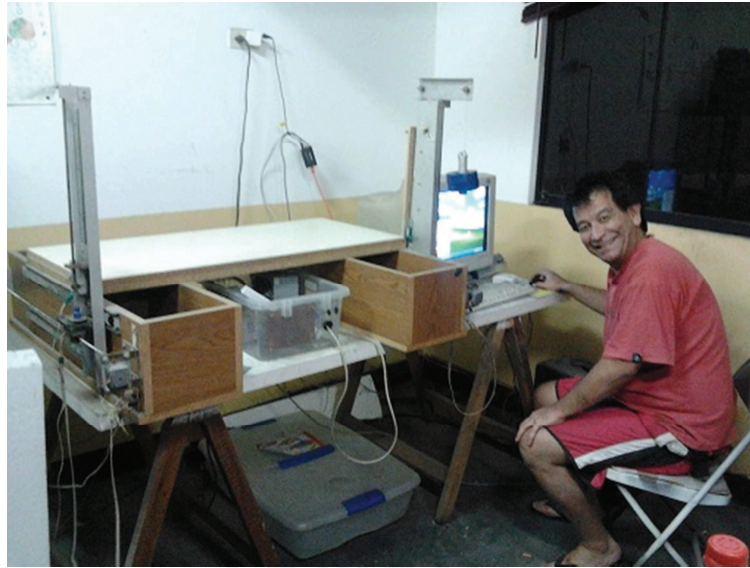
Figura 3. 1 Máquina de corte por alambre caliente de nicrom. [Eduardo Massoni, 2012].
