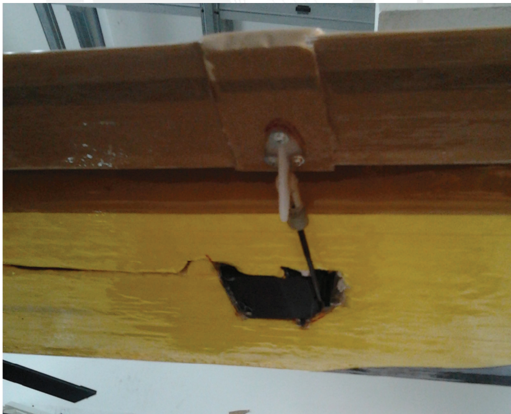
Figura 3. 19 Detalle de instalación del servo del alerón. [Autoría propia, 2012].
