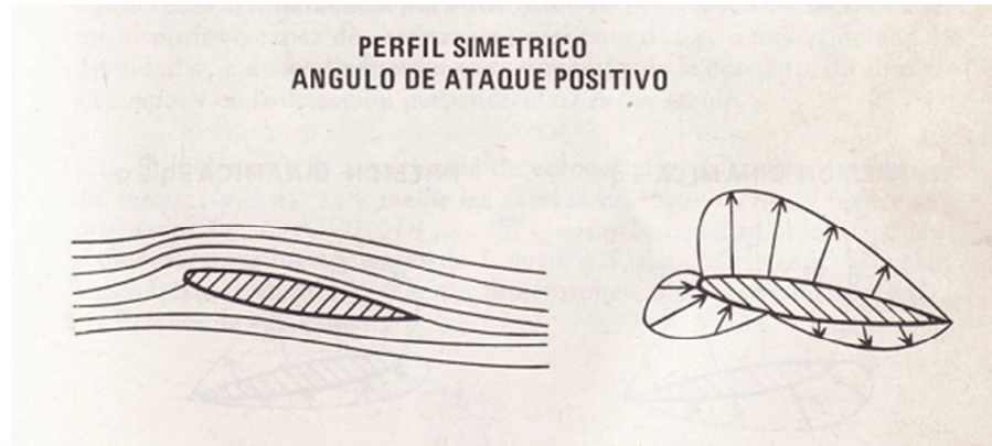
Figura 1. 3 Líneas de flujo y distribución de presiones para un perfil aerodinámico simétrico con un ángulo de ataque mayor a cero grados. [Carmona, 1987].
