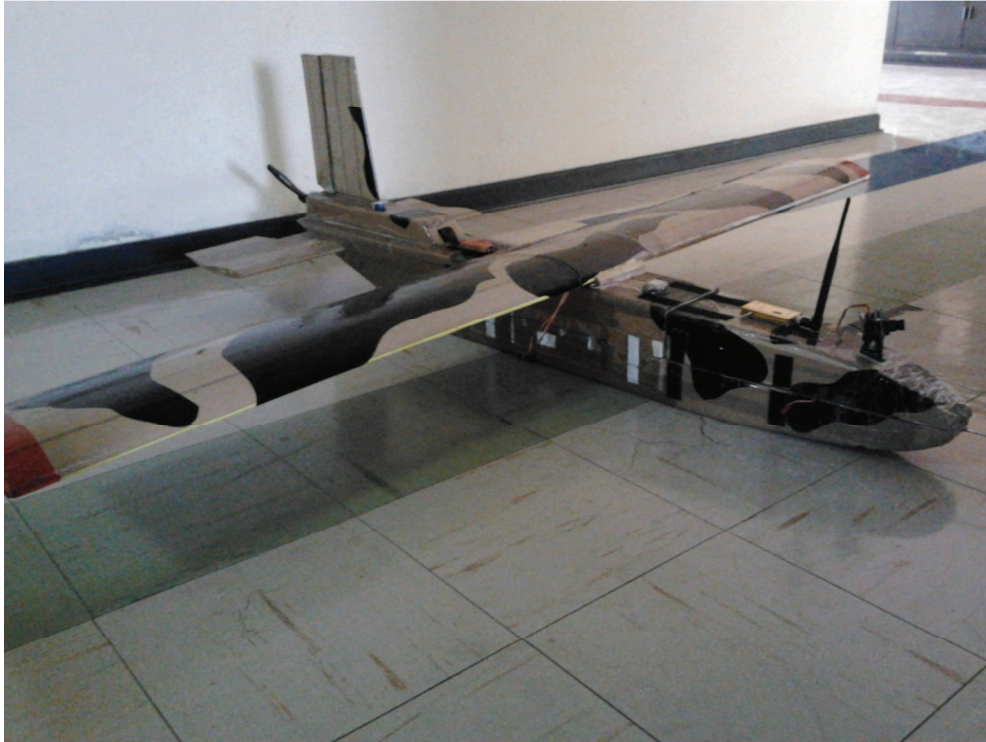
Figura 3. 22 VANT ensamblado y equipado antes del vuelo. [Autoría propia, 2013].
