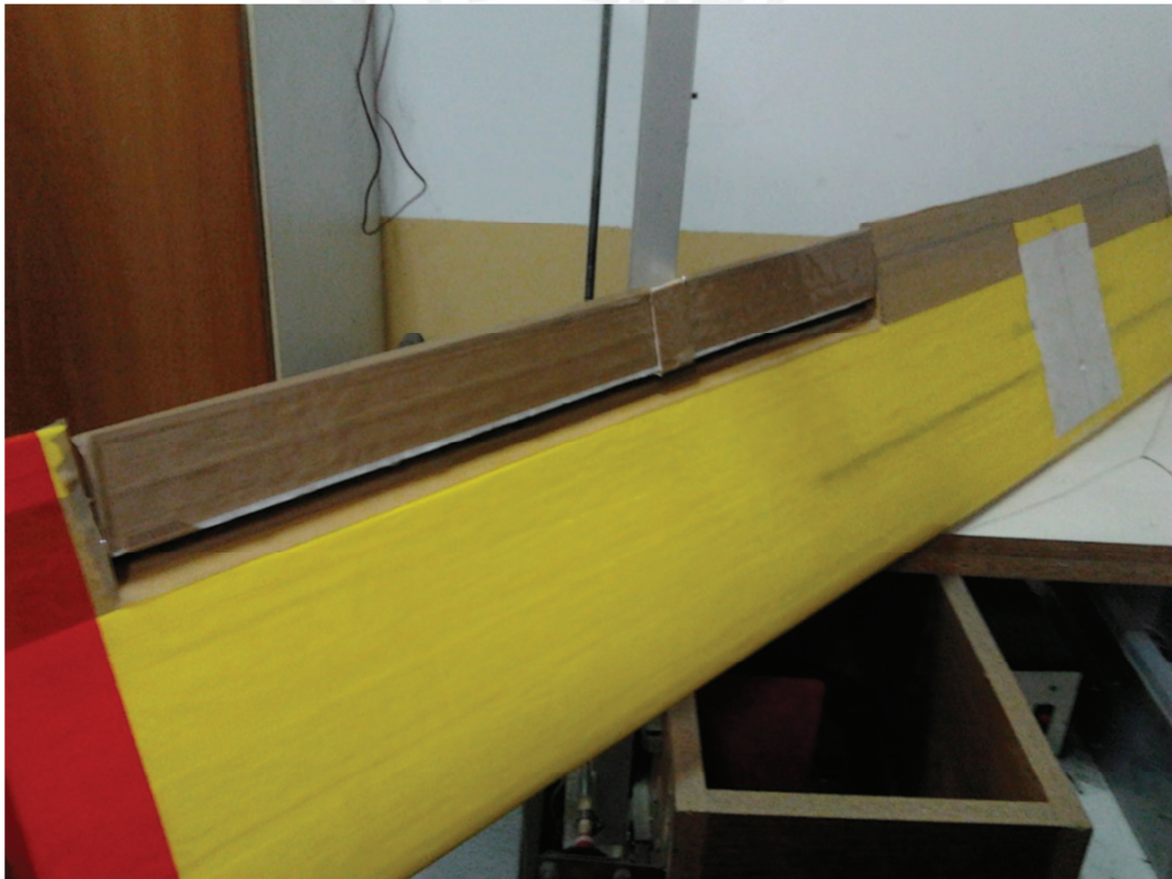
Figura 3. 7 Superficie de control del ángulo de alabeo. [Autoría propia, 2012].
