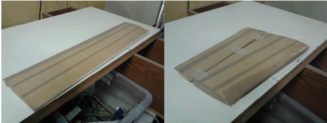
Figura 3. 8 Superficies de control de timón y elevador, ángulos de guiñada y cabeceo respectivamente. [Autoría propia, 2012].
