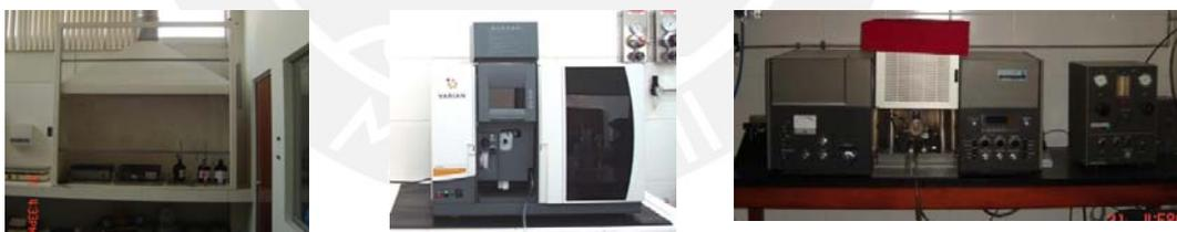
**Figura 1.9 Distribución Zona B: Campana tipo gabinete y Distribución Zona C y D: Espectrofotómetros Varian AA240 y Perkin Elmer 403**
