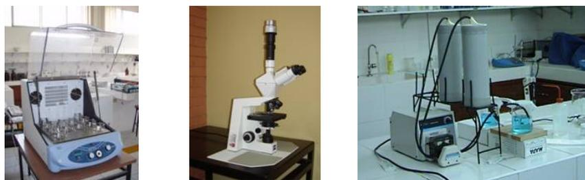
Figura 1.4 Incubadora Banstead, Microscopio Axiostar y Bomba Peristálticas Sercal .
