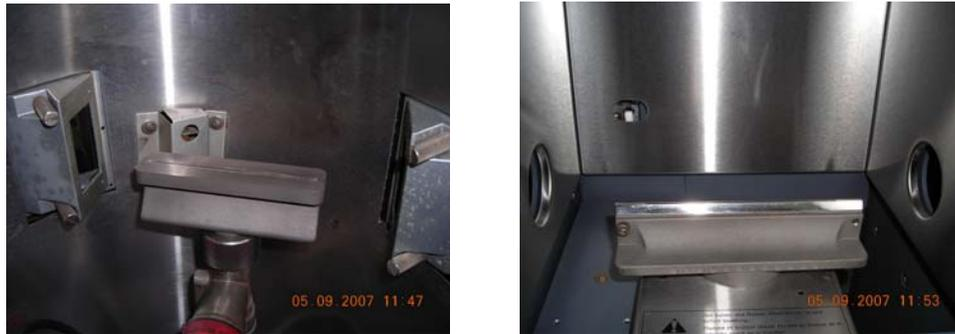
Figura 2.18 Difusor de Espectrofotómetro Perkin Elmer 403 y Varian AA240
