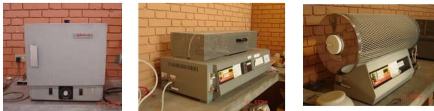
Figura 1.11 Mufla y Gallenkamp Brit Pat 882942, Horno Rotativo Carbolite Type HTR 11/75 y Tubular GHA12/300
