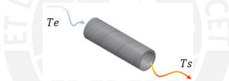
Figura 3.8. Parámetros de temperatura de fluidos en conductos.
