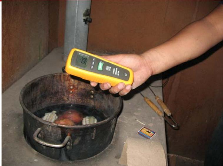
Figura 3.18: Monitoreo de la concentración de CO en el ambiente interior.
