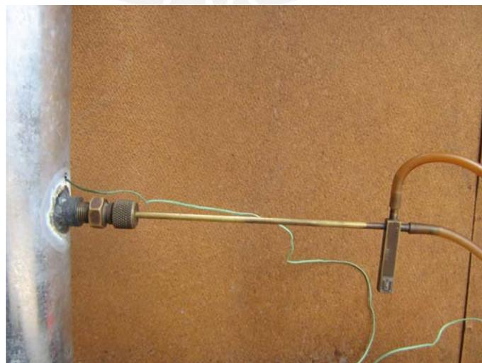
Figura 1.2a: Tubo de Pitot colocado en chimenea
