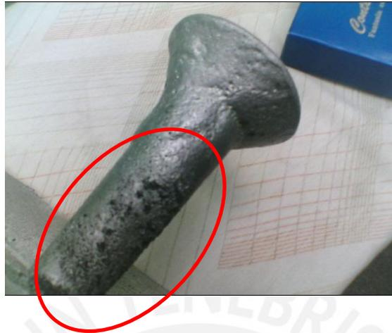
Figura 2.12: Defecto de erosión e inclusión de arena en la superficie del bebedero
