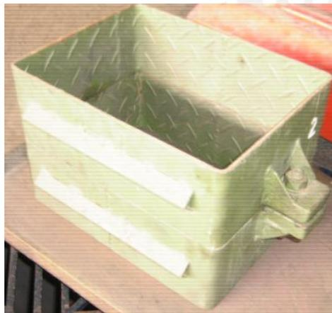
Figura 2.5: Bastidor de moldeo
