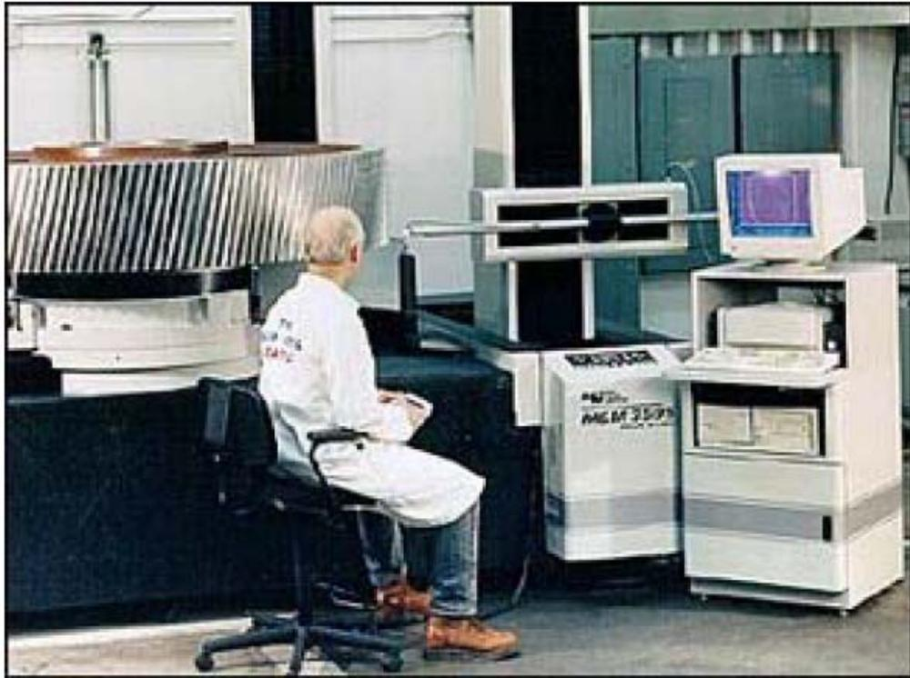
**Figura 2.2.** Máquina de medición por coordenadas analizando un engranaje helicoidal. [5]
