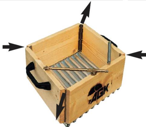
Figura 1.6 Cajón seleccionador indicando su desplazamiento 8
