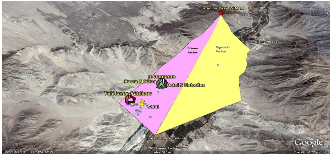
Figura 28. Sectorización de la Estación Base WiMAX. [24]
