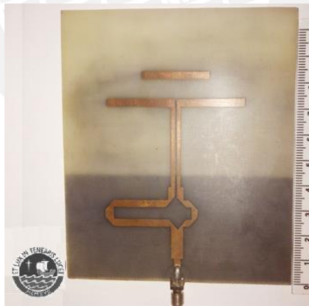
FIGURA 4-5: ANTENA QUASI YAGI CONSTRUIDA.
