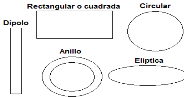
FIGURA1-4: FORMATOS COMUNES ADOPTADOS PARA EL ELEMENTO RADIADOR
