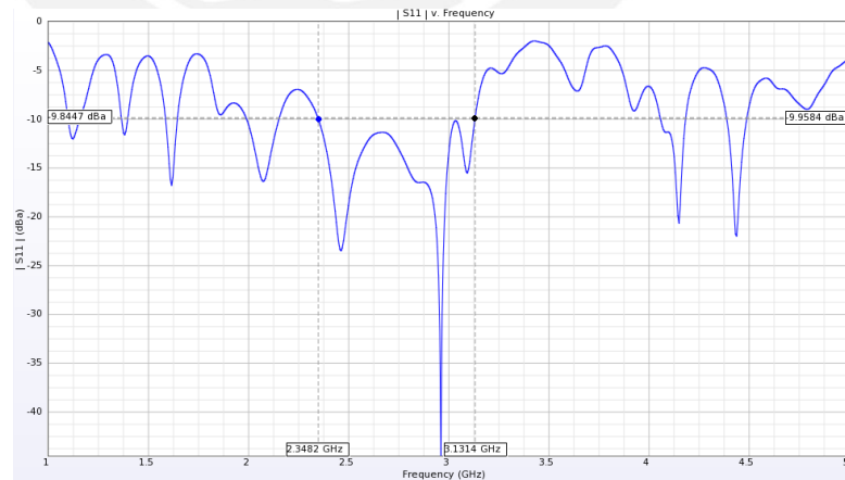
FIGURA 4-29: PÉRDIDA DE RETORNO DEL ARREGLO DE CUATRO ELEMENTOS QUASI YAGIS PARA APLICACIONES BEAMFORMING
