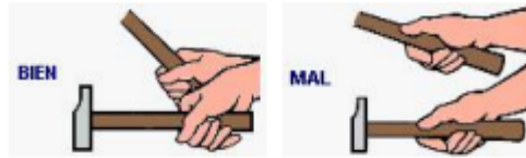
Figura 9: Forma de sujeción del martillo
