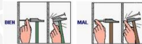
Figura 11: Forma de sujetar el clavo al golpear
