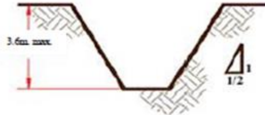
TALUD SIMPLE - TIEMPO CORTO* TIPO DE SUELO A Hasta 3.6 metros de profundidad Talud máximo permitido 1/2:1 *abierto 24 horas o menos
