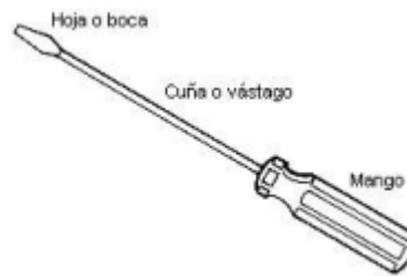
Figura 16: Partes de un destornillador
