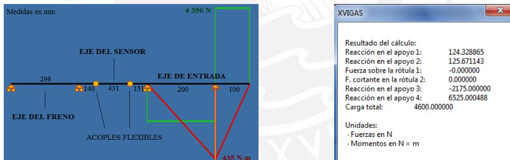
Figura I.12. Diagramas de fuerzas internas para el caso de diseño con acoples flexibles (rótulas). Fuerzas cortantes (Verde). Momentos flectores (Rojo).
