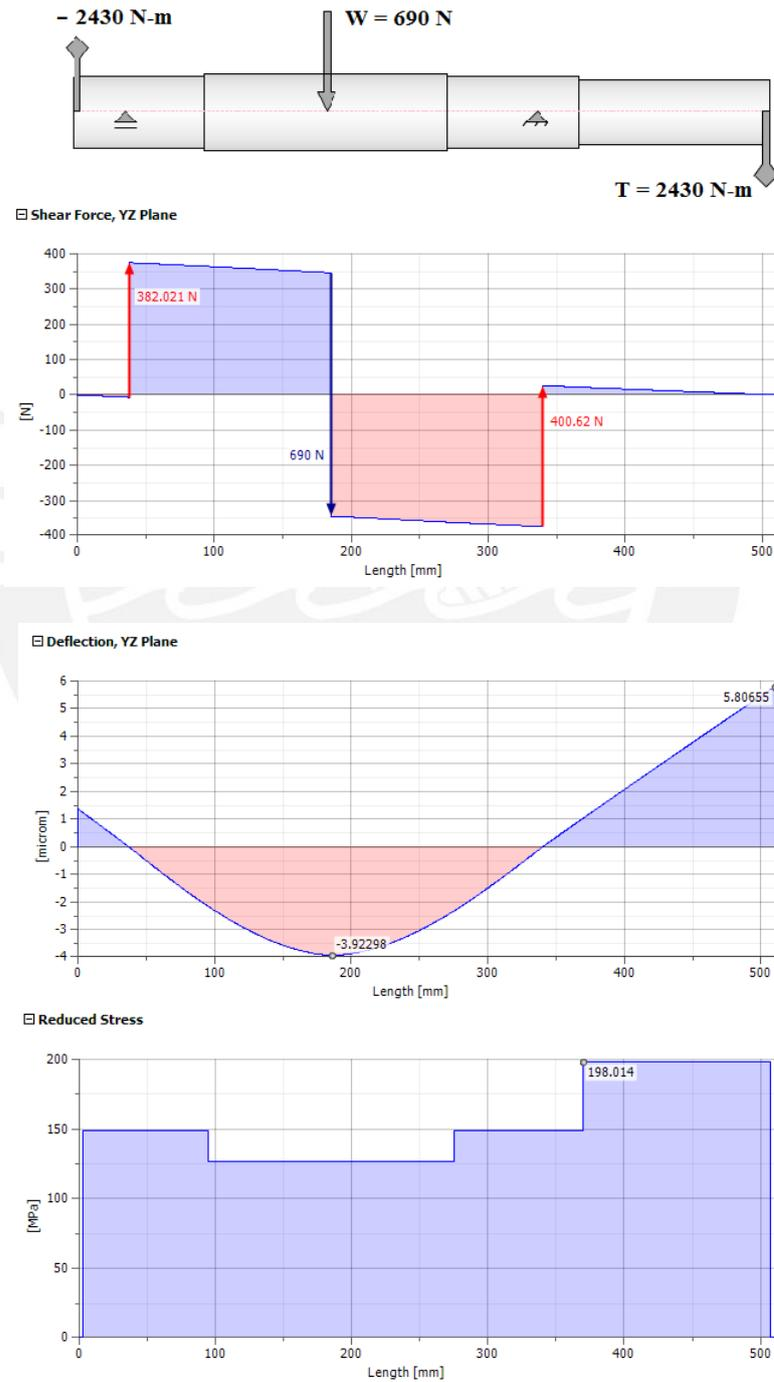
Figura I.13. Diagramas de fuerzas internas, deflexiones y esfuerzos del árbol del freno.
