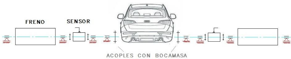
Figura 2.11. Concepto de solución definitivo. Vista trasera esquemática.
