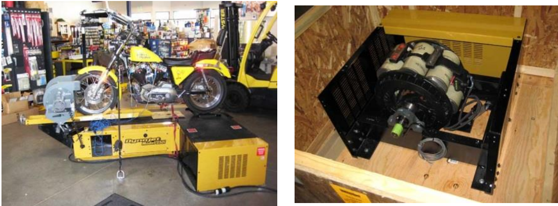
Figuras 1.9. Izquierda: Dinamómetro de la marca DynoJet 250I con una motocicleta Sportster lista para ser ensayada. Derecha: Su freno de corrientes parásitas 11 .
