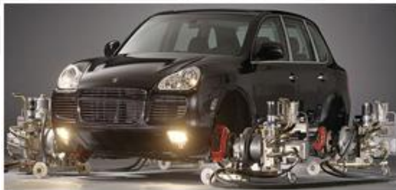
Figura 1.6. Dinamómetro acoplable conectado a los ejes de una 4x4 7 .
