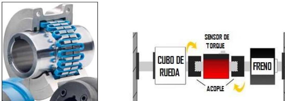
Figura 4.12. Izquierda: Acople de grilla. Derecha: Esquema de instalación de los acoples
