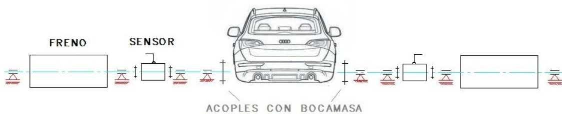
Figura 3.5. Vista trasera de la instalación del dinamómetro. Se aprecian las chumaceras de los ejes en rojo, más no se aprecia la estructura metálica ni los soportes principales del equipo.
