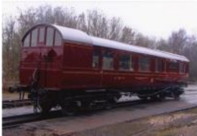
Figura 1.2. Dinamómetro carro británico para ferrocarriles 3 de los años 30'.
