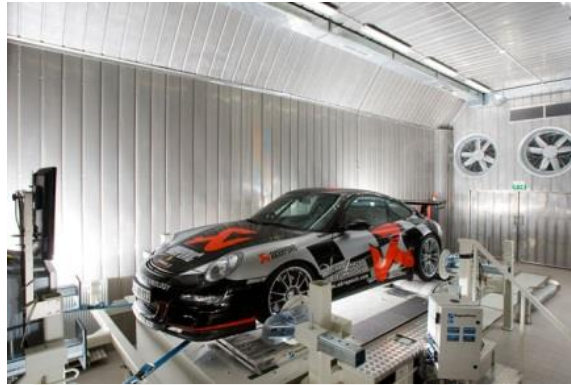
Figura 1.1. Dinamómetro de chasis moderno con ventilación en sala 2 .
