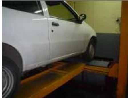
Figura 1.10. Dinamómetro de inercia de rodillo simple de Roller Test 12 .
