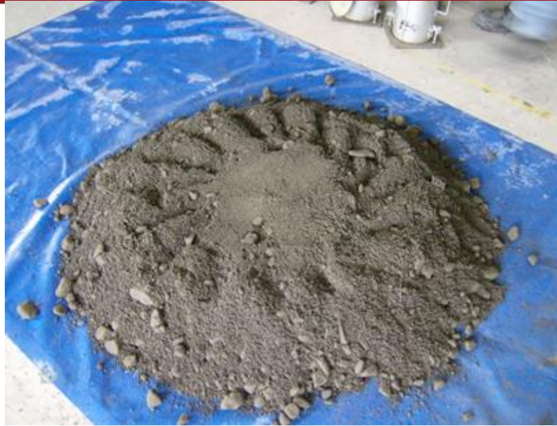
Fig. 3.15. Mezcla de CCR diseñada
