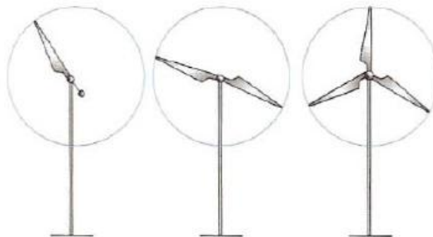
Figura 1-10. Aerogeneradores de una, dos y 3 palas en la hélice [15]
